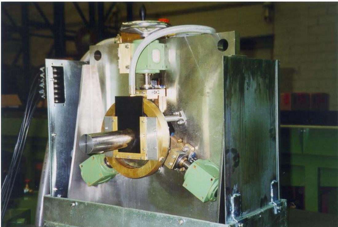
Bild 5. Einlaufseite des Prüfsystems mit Stellspindeln und Vorbenetzung. Die Positionierung aller Prüfkopfträger erfolgt zentral mit einem Handrad oder einem Motor. Die Kraftübertragung erfolgt über einen Zahnriemen (siehe Bild 3).
