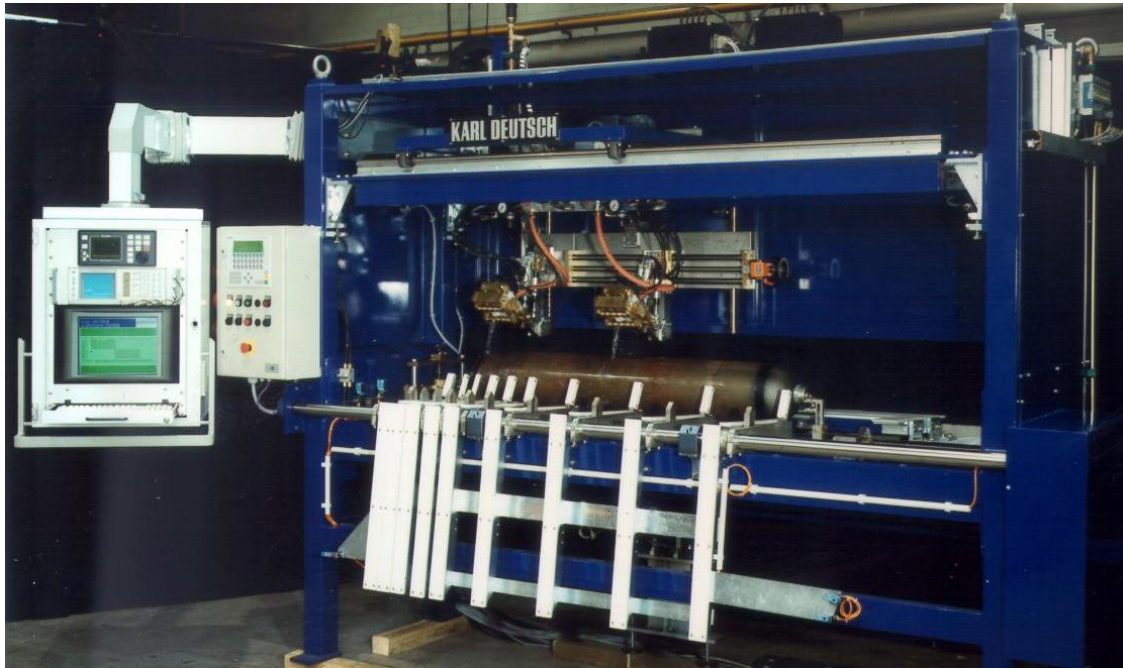
Bild 4. Eine komfortable Bedienung ist mit einem Bedienterminal (BAG) möglich, welches an einem Schwenkarm aufgehängt ist. Im Terminal ist ebenso ein Ultraschall-Prüfgerät vom Typ ECHOGRAPH 1085 integriert, mit dem die manuelle Bodenprüfung durchgeführt wird.
