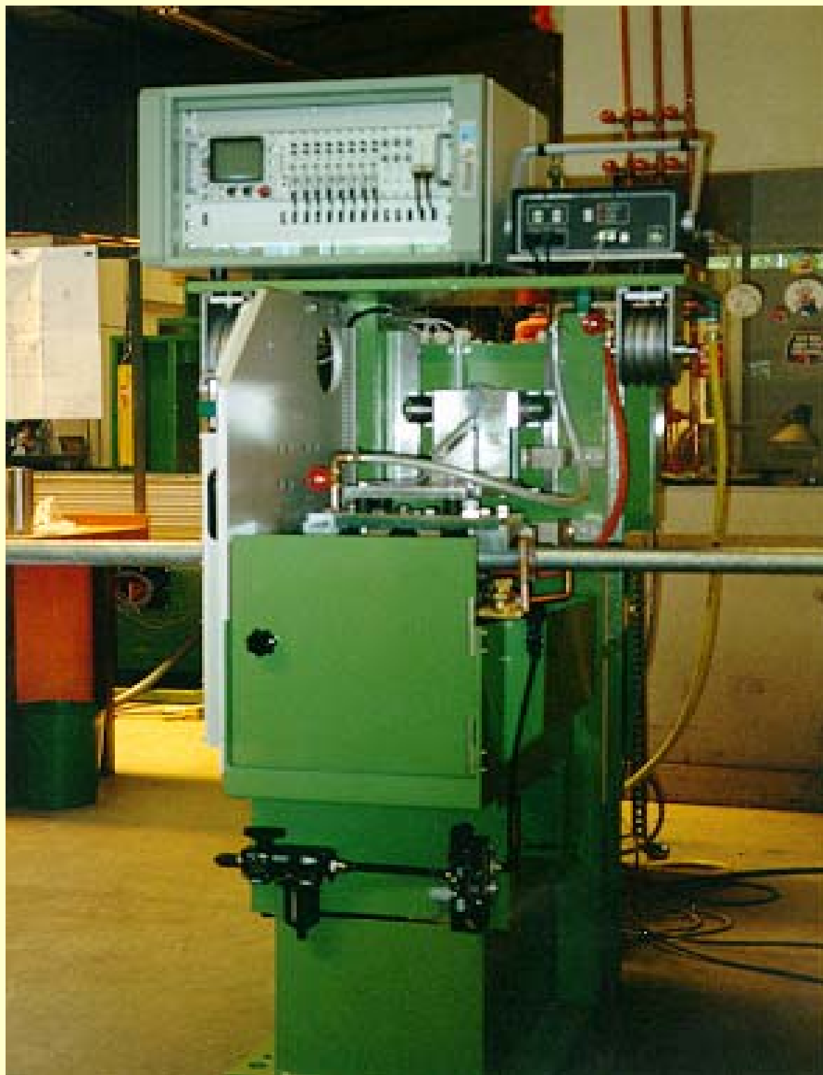
Prüfanlage für Stangen mit runden Querschnitten RPS.S-ECHOGRAPH 1030-6L/2S-20/80
