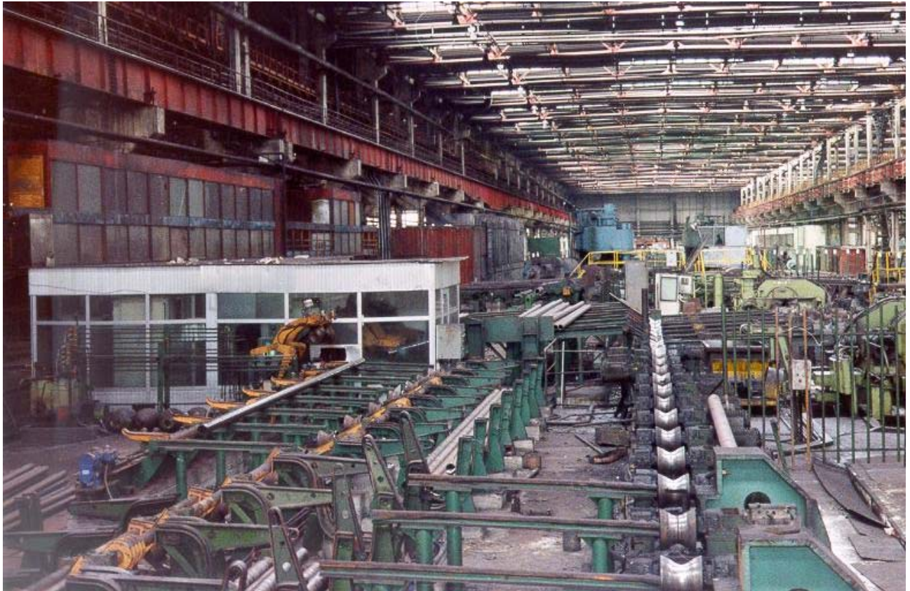
Bild 1. Gesamtansicht des Rotier-Prüfsystems bei ARTROM, Rumänien. Der Rohrdurchmesser für diese Anlage liegt zwischen 20 und 203 mm.
